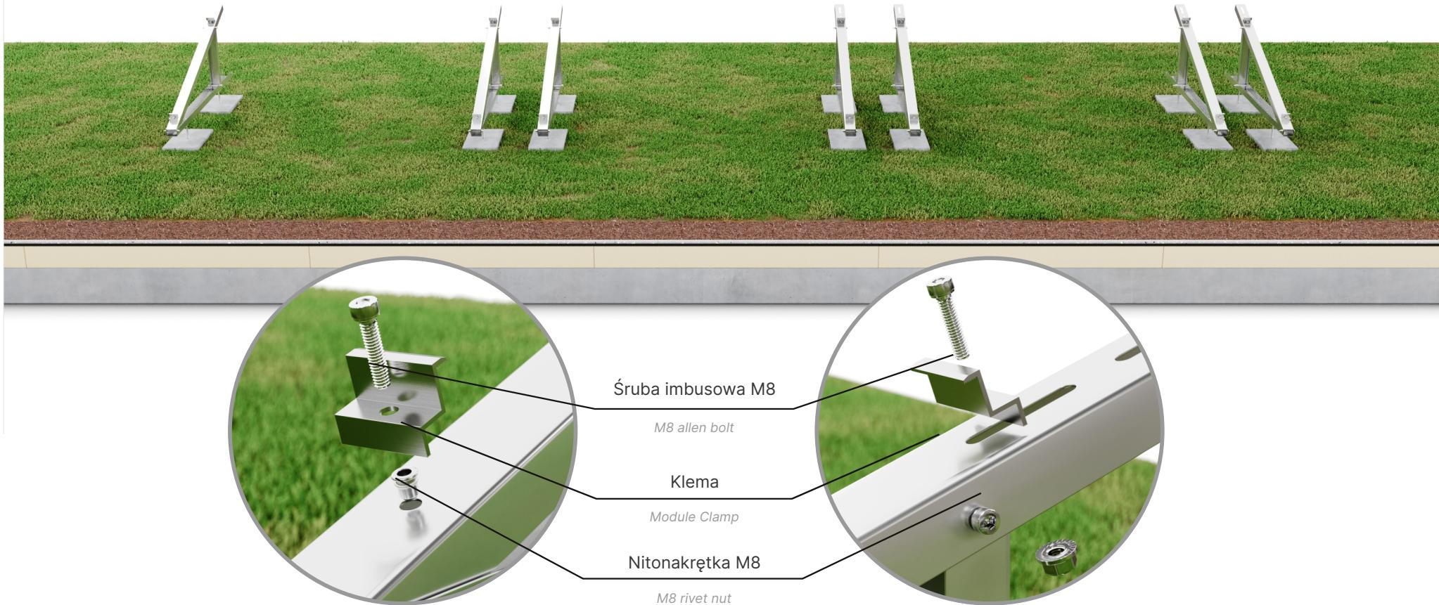
W otworach w dolnej i górnej części trójkąta znajdują się nitonakrętki M8. Przymocuj klemy za pomocą śrub imbusowych, klemy powinny luźno wisieć, zostaną one przykręcone w czasie zakładania kolejnych modułów.
