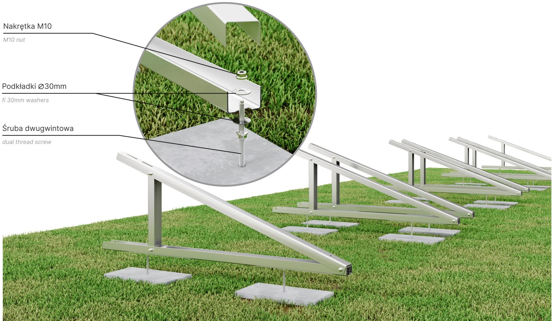
Przykręć trójkąty za pomocą śrub dwugwintowych (2szt. na trójkąt) nakrętek M10 i podkładek fi 30mm do bloczków betonowych. Zalecana kotwa chemiczna.
