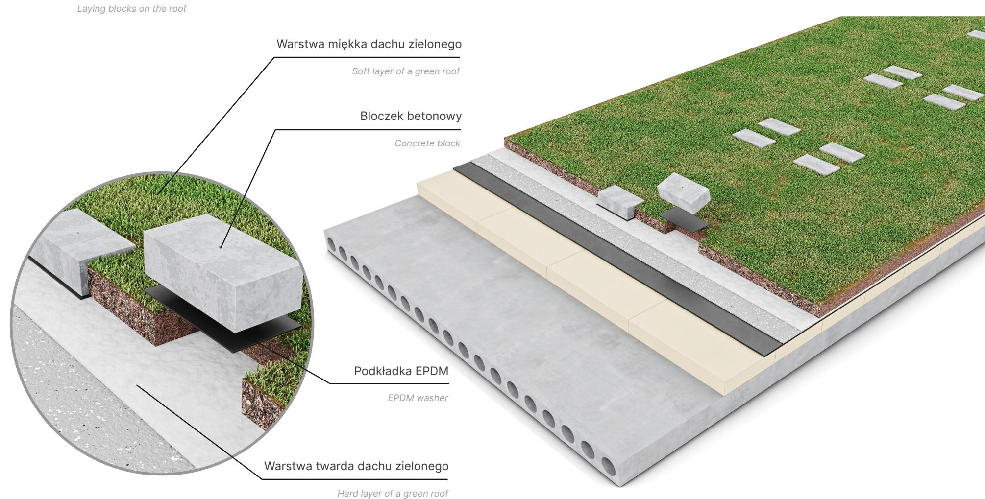
W miejscu ułożenia bloczków betonowych odkryj miękką warstwę dachu zielonego. Zwróć szczególną uwagę, aby nie uszkodzić warstwy izolacyjnej czy membrany. Pod każdy bloczek betonowy podłoż podkładkę EPDM. Bloczki powinny być posadowione na twardej warstwie dachu zielonego.
