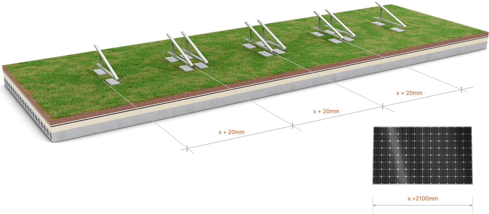
Rozmieść bloczki betonowe na szerokość modułu fotowoltaicznego + 20mm
