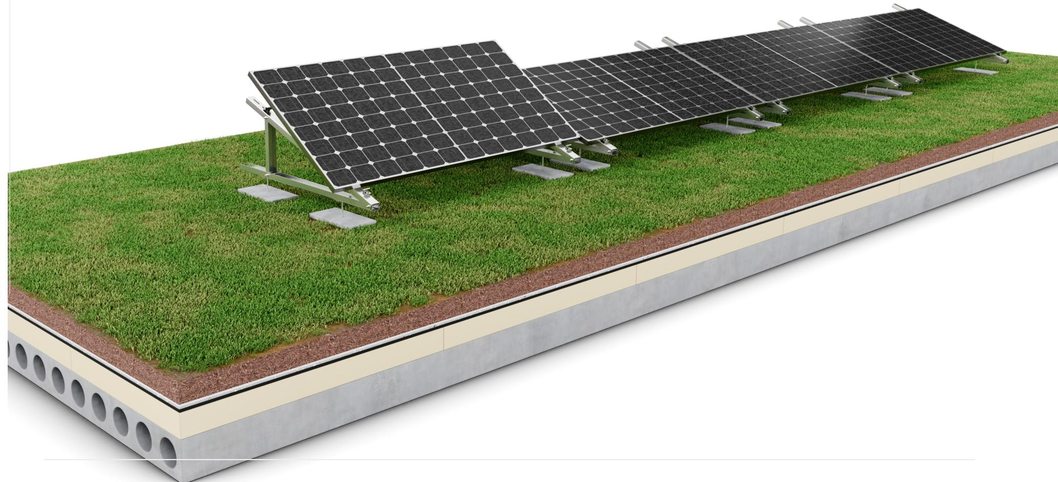
Na tak przygotowanej konstrukcji rozmieść moduły dokręcając klemy kolejno po ułożeniu każdego następnego modułu. Klemy powinny znaleźć się na odpowiedniej wysokości modułu, zgodnie z zaleceniami instrukcji montażu modułów fotowoltaicznych.
