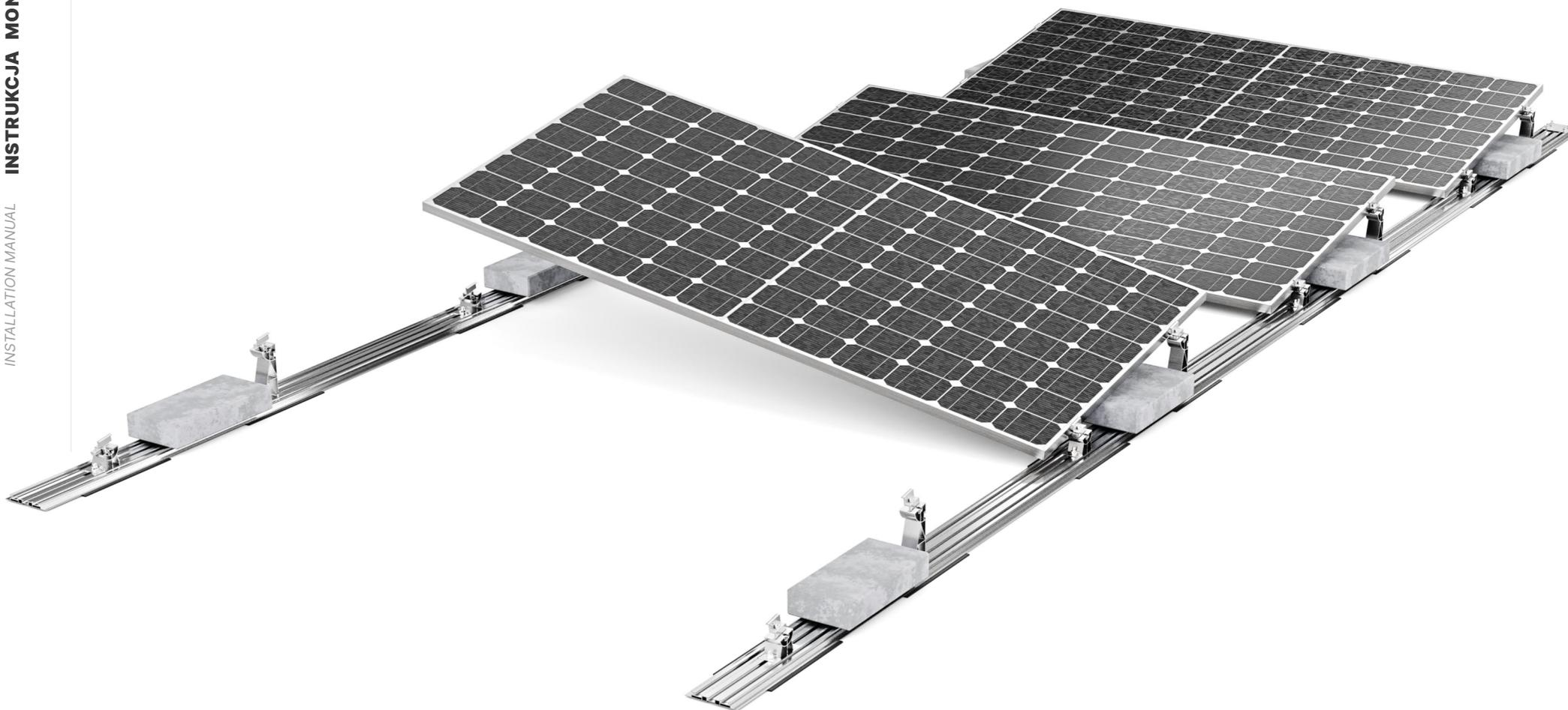
Na tak przygotowanej konstrukcji rozmieść moduły dokręcając klemy kolejno po ułożeniu każdego następnego modułu. Klemy powinny znaleźć się na odpowiedniej szerokości modułu, zgodnie z zaleceniami instrukcji montażu modułów fotowoltaicznych.
