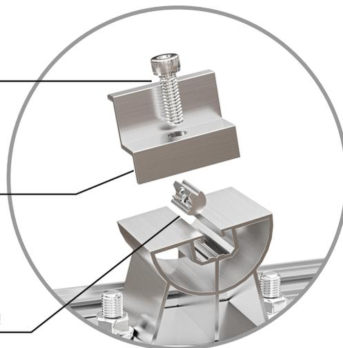
W górnym kanale podpory umieść wpust przesuwny. Wpust przesuwny konstrukcyjnie przystosowany jest do włożenia od góry w dowolnym miejscu kanału. Po założeniu wpustów lekko przymocuj klemy za pomocą śrub imbusowych M8, klemy mogą luźno zwisać, zostaną one przykręcone w czasie zakładania modułów.
