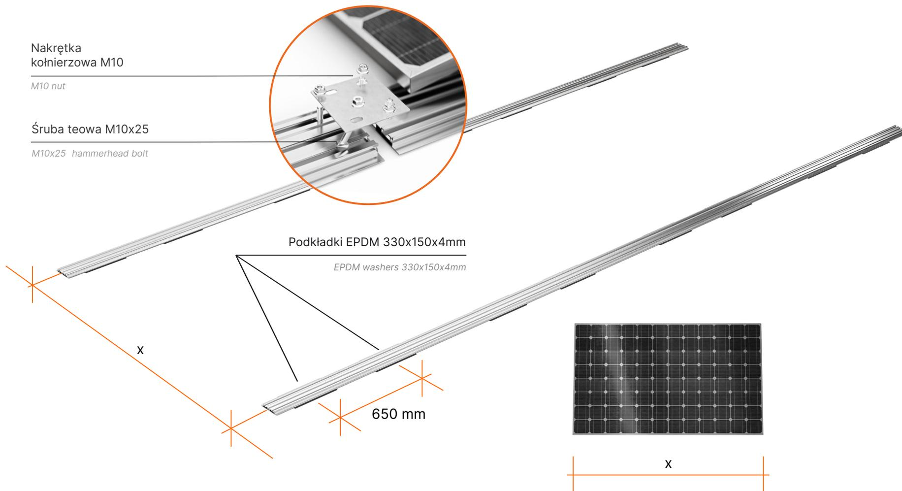
Rozmieść szyny W-H na szerokość modułu PV. W miejscach podpór podłóż podkładki EPDM 330x150x4mm. Podpory mają średni rozstaw 650mm (w zależności od rodzaju modułu). W razie konieczności połącz szyny W-H łącznikiem za pomocą 4 śrub młotkowych M10x25mm i nakrętek M10.
