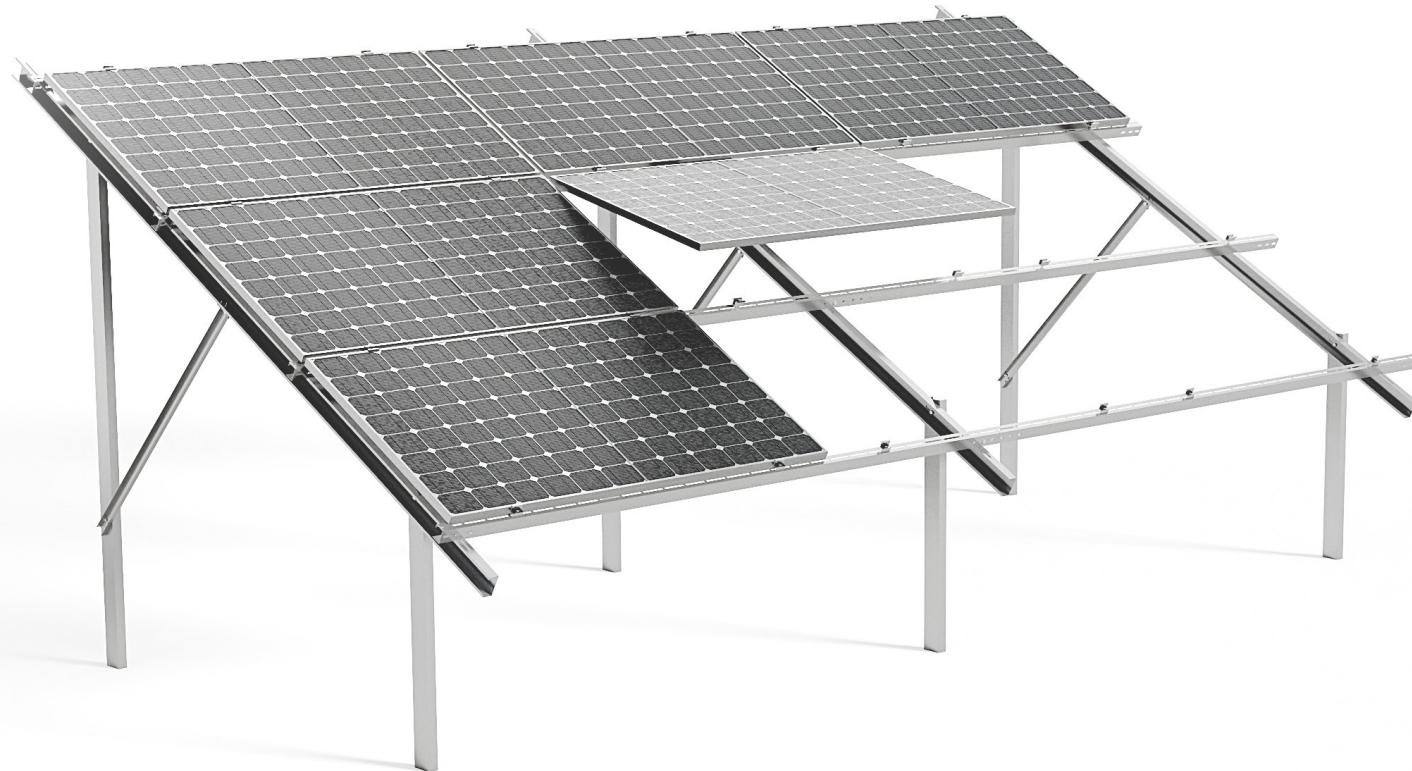
Na tak przygotowanej konstrukcji rozmieść moduły dokręcając klemy kolejno po ułożeniu każdego następnego modułu. Klemy powinny znaleźć się na odpowiedniej szerokości modułu, zgodnie z zaleceniami instrukcji montażu modułów fotowoltaicznych.
