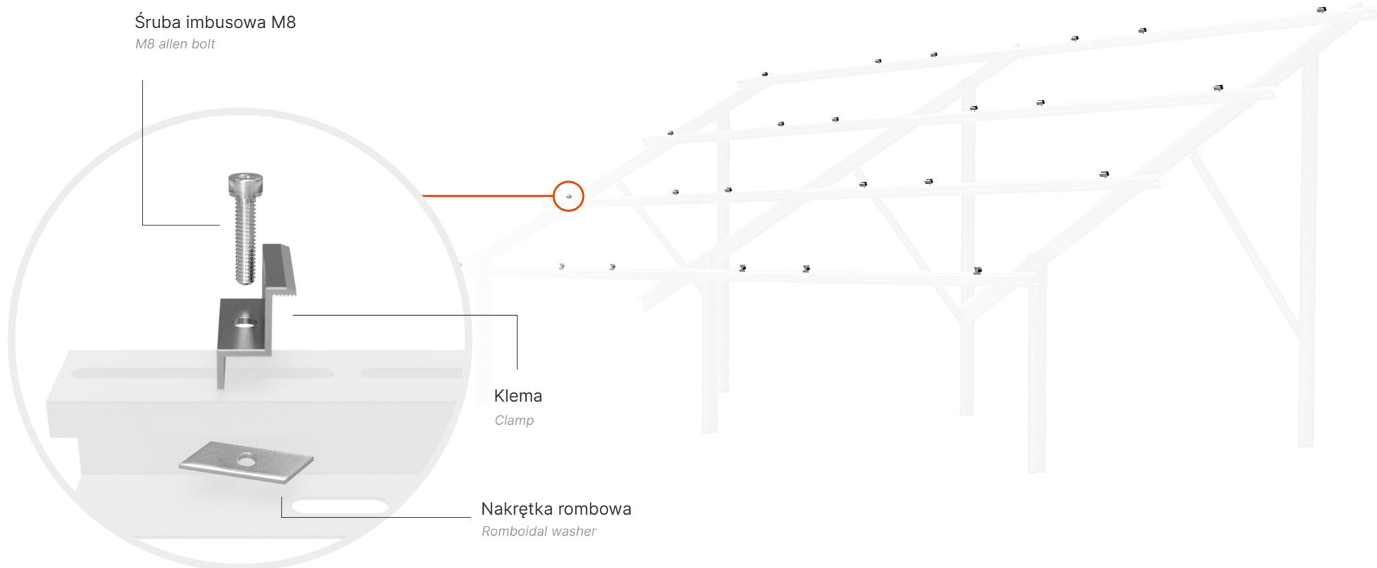
Rozmieść klemy na belkach poprzecznych używając podłużnych otworów 9mm na górnej części belki oraz śrub imbusowych M8 i nakrętek rombowych.
