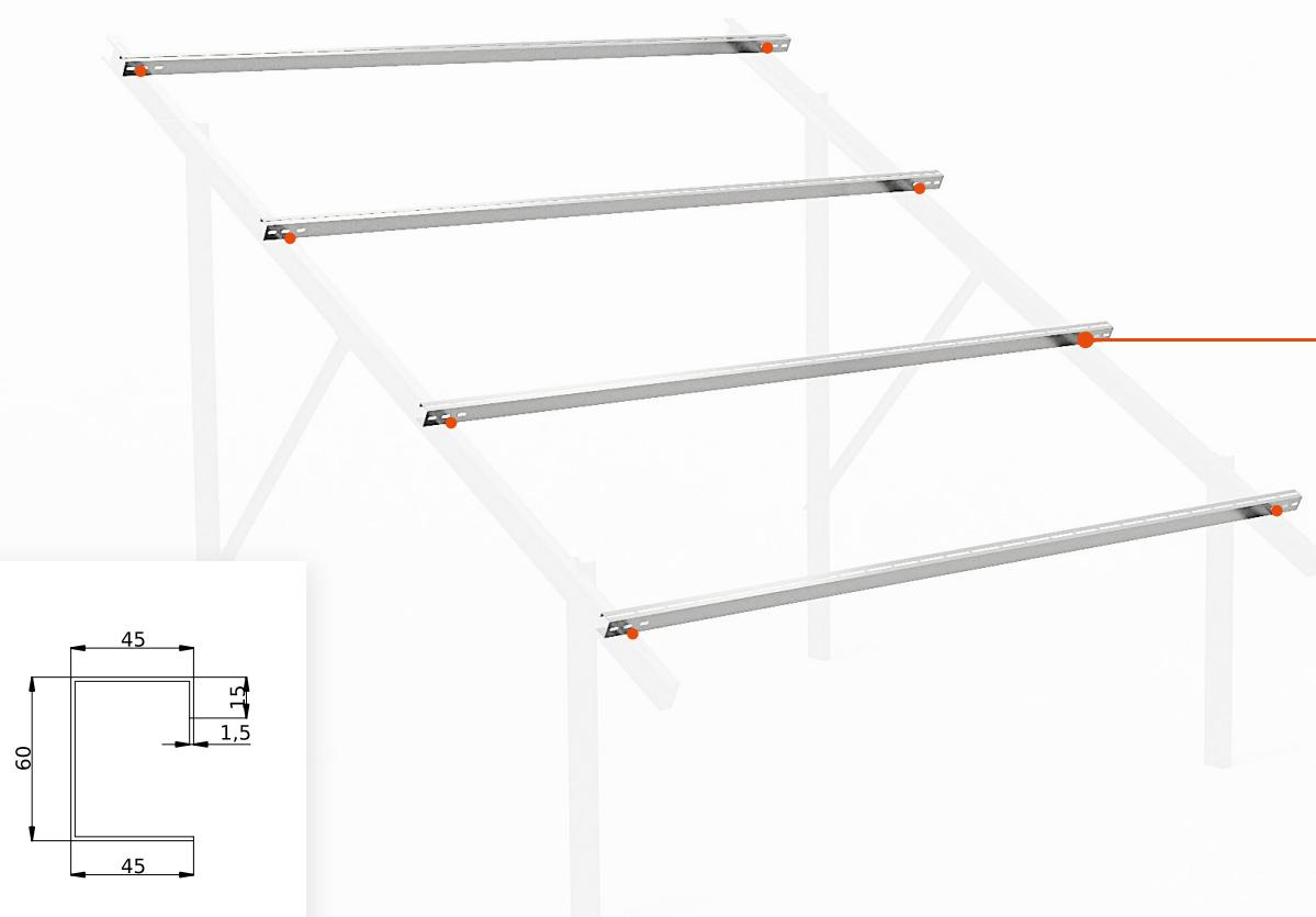
Beleki poprzeczne przykręć za pomocą śrub M10 do belek głównych wykorzystując otwory o średnicy na dolnej części belek poprzecznych. Pierwsza belka zawsze musi mieć 2 punty podparcia jak na powyższym rysunku.
