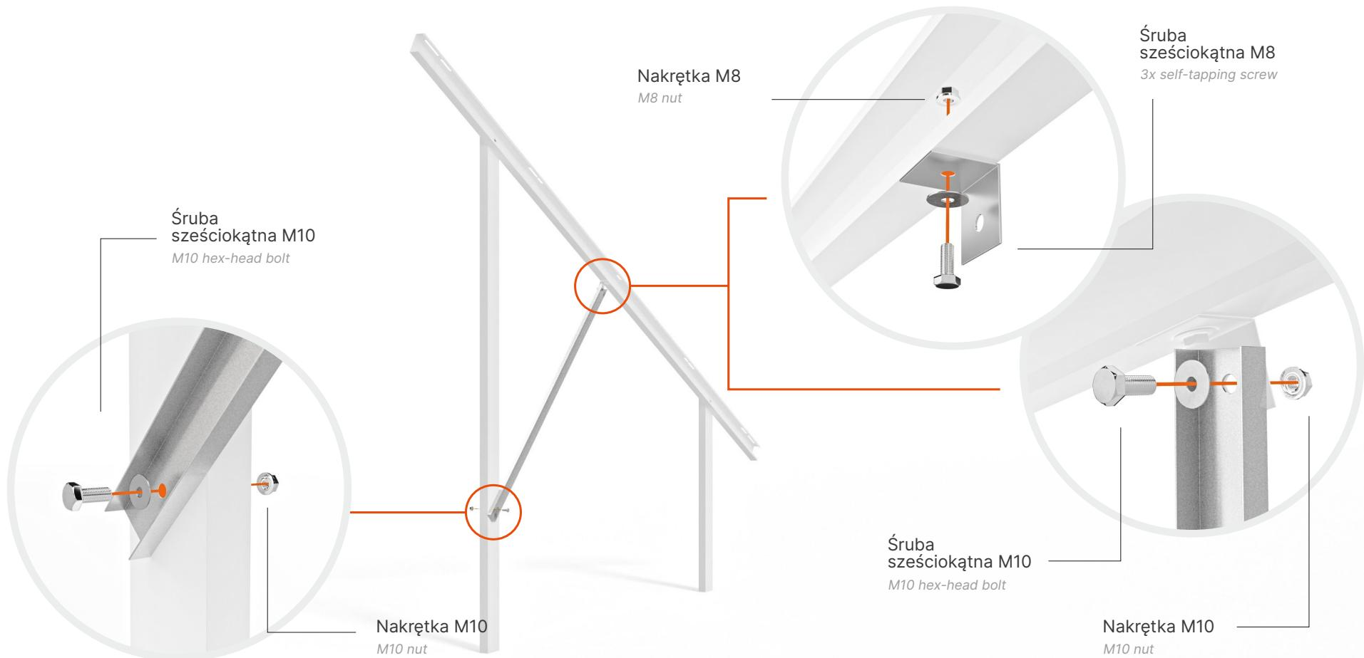
Dopasuj pomiędzy tylną podporę a belką główną zastrzał z blaszką mocującą. Zastrzał połącz z blaszką i podporą tylną za pomocą śruby M10 natomiast blaszkę z belką główną połącz za pomocą śruby M8.
