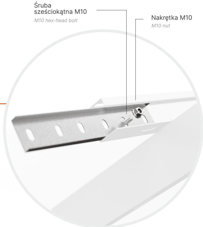
Wykorzystując otwory umiejscowione na bocznej części belek poprzecznych i śruby M10 zamontuj łączniki belek, do których dokręcane będą kolejne belki poprzeczne.
