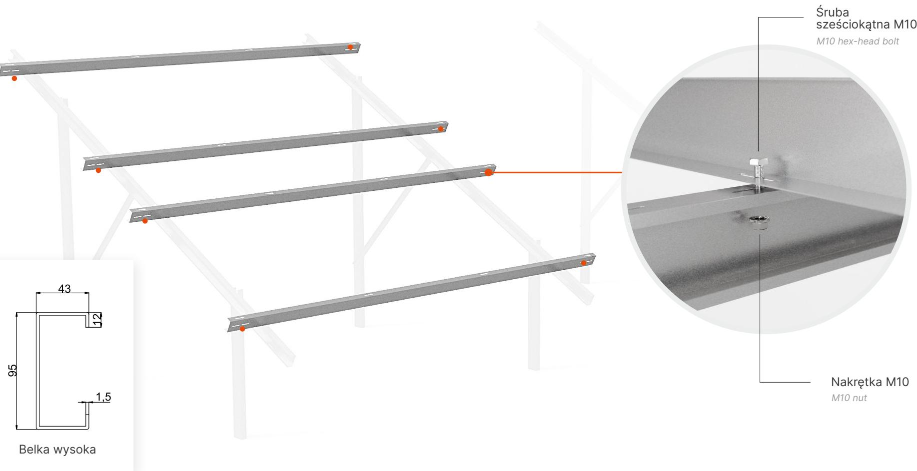
Belki poprzeczne przykręć za pomocą śrub M10 do belek głównych wykorzystując otwory o średnicy na dolnej części belek poprzecznych.
