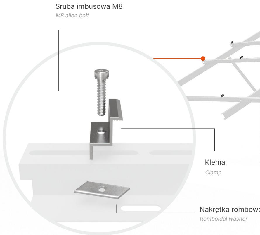
Rozmieść klemy na belkach poprzecznych używając podłużnych otworów 9mm na górnej części belki oraz śrub imbusowych M8 i nakrętek rombowych.
