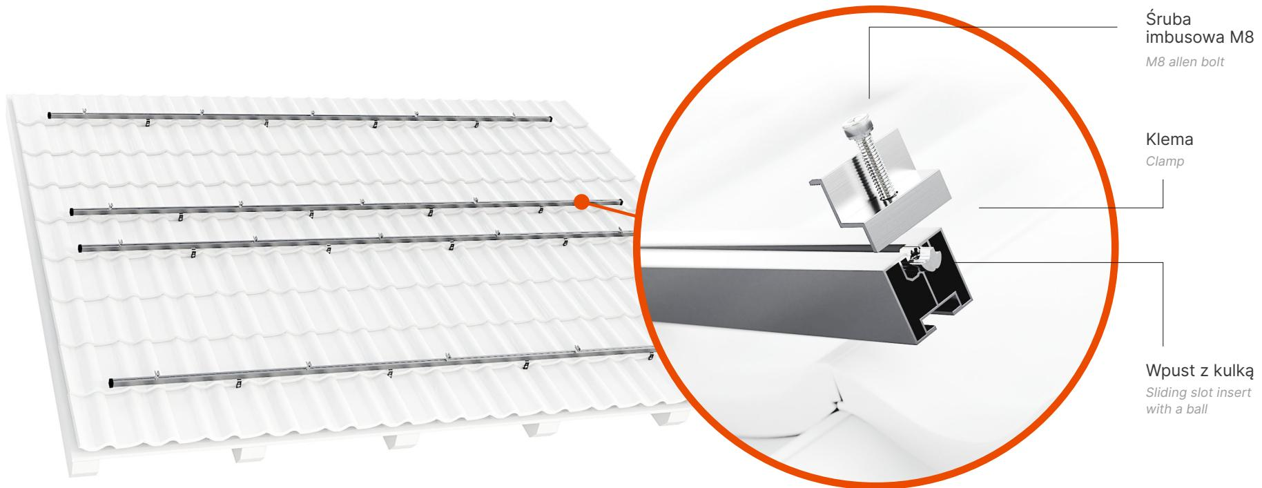
W górnym kanale profilu umieść wpust przesuwny. Wpuszt przesuwny konstrukcyjnie przystosowany jest do włożenia od góry w dowolnym miejscu kanału. Po rozmieszczeniu wpustów lekko przyjmocuj klemy za pomocą śrub imbusowych, klemy powinny luźno wisieć, zostaną one przykręcane w czasie rozkładania kolejnych modułów.
