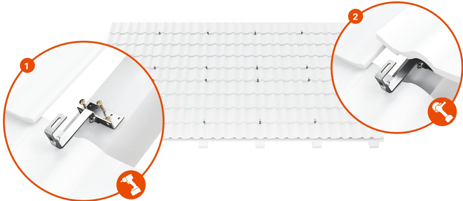
1. Zdejmij ostrożnie dachówkę tak, aby odsłonić krokwie. W zależności od potrzeby możesz użyć uchwytów z regulacją bądź bez. Umieść uchwyt montażowy tak, aby umożliwić przymocowanie do krokwi za pomocą śrub mocujących. Zachowaj odstęp minimum 3-5mm pomiędzy uchwytem a dachówką.
