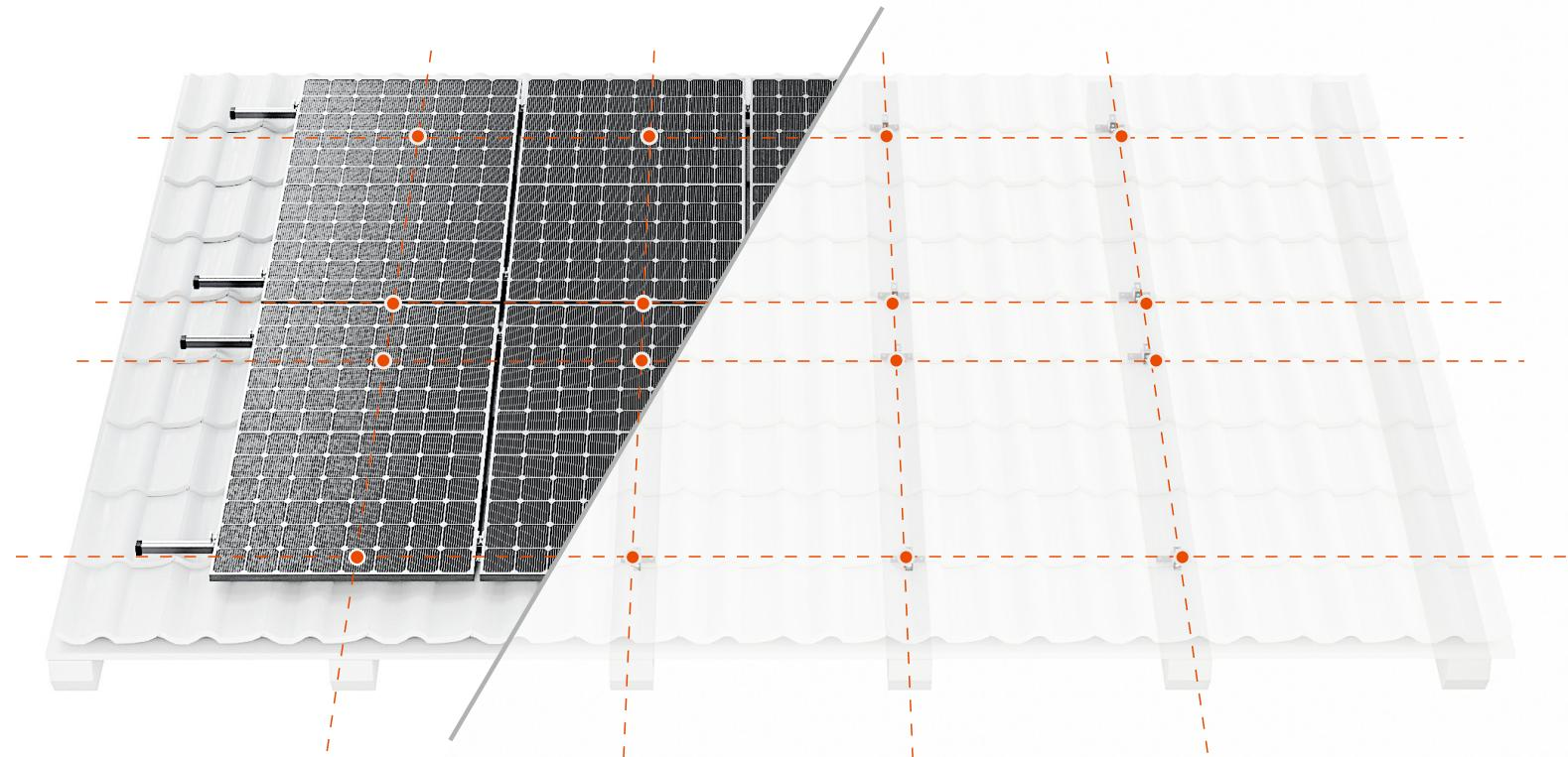
Rozplanuj rozmieszczenie uchwytów tak aby profile montażowe na których opierać się będą moduły umieszczone były w odpowiednich odstępach od krawędzi modułów i wspierały równomiernie całą masę modułów.
